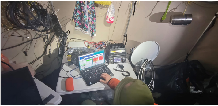
Hilberling QO-100 Anlage von HB9RYZ im Zelt mit 35-cm-Spiegel
