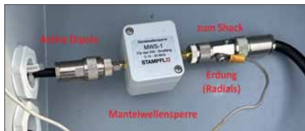
Bild 7: Mantelwellensperre für den Aktiv-Dipol auf dem Dach
